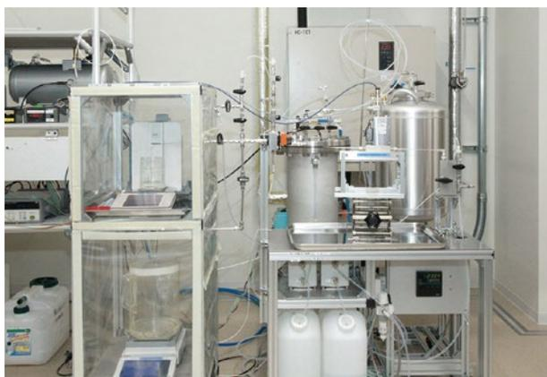
微小液体流量标准仪器。高精度地测量重量和时间，可测量微小液体流量（g/分），以 5 分钟装满一茶匙为例。阿自倍尔开发的标准仪器。
