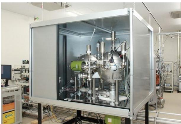
真空发生器（膨胀法装置）利用波义耳定律可产生 1~1000 Pa（大气压的 1/100000~1/100）左右的高精度真空。阿自倍尔开发的标准仪器。
