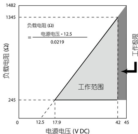
**图 2 电源电压和负载电阻特性**
