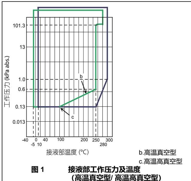
**图 1 接液部工作压力及温度 (高温真空型/ 高温高真空型)**
