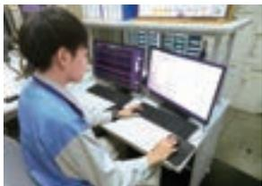
BiG EYESのトレンド監視ビューア（左）とコンフィギュレータ（設定）画面（右）。監視対象に関連するポイントを登録し、監視モデルを作成する。他社DCS※とオンラインで接続し監視を行う。
