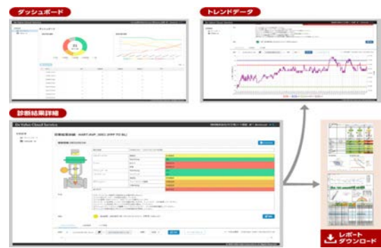
▲Web上のダッシュボードで全体感を把握し、バルブ個別の健全性は診断結果詳細画面で確認が可能
